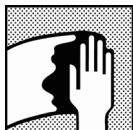
Предварительная очистка поверхности с теплой водой и моющим средством, ополаскивание чистой водой.
