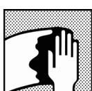
Очистка поверхности: удаление всех загрязнений с поверхности перед нанесением 1K All Plastics Primer подходящим обезжиривателем. С использованием очистителя M700.
