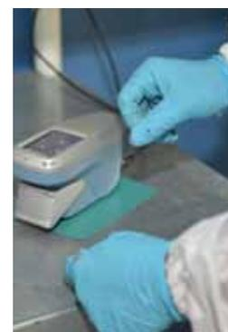
*Основной инструмент – это компактный спектрофотометр AkzoNobel Automatchic Vision, работающий в паре с программным обеспечением Color Manager*
