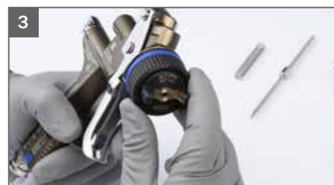
3 Установите воздушную головку
