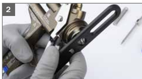
2 Затяните дюзу при помощи универсального ключа
