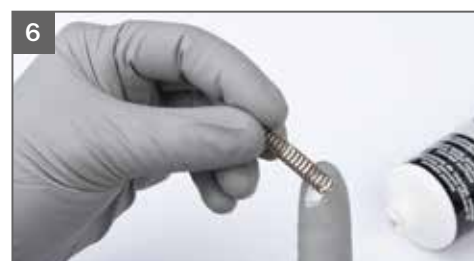
6 Смажьте и вставьте пружину окрасочной иглы
