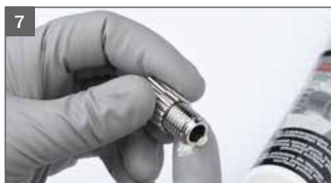
7 Смажьте резьбу винта-регулятора подачи материала
